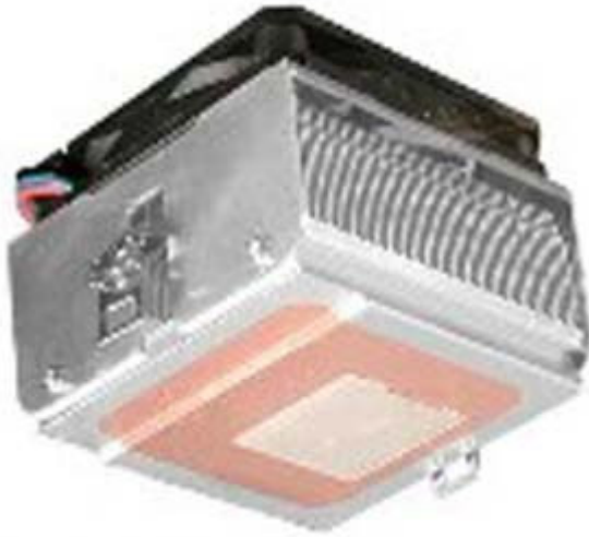
Disipadores para socket tipo 7/A y similares. Vean el rebaje en uno de los lados para ajustar en la parte superior del zócalo.
