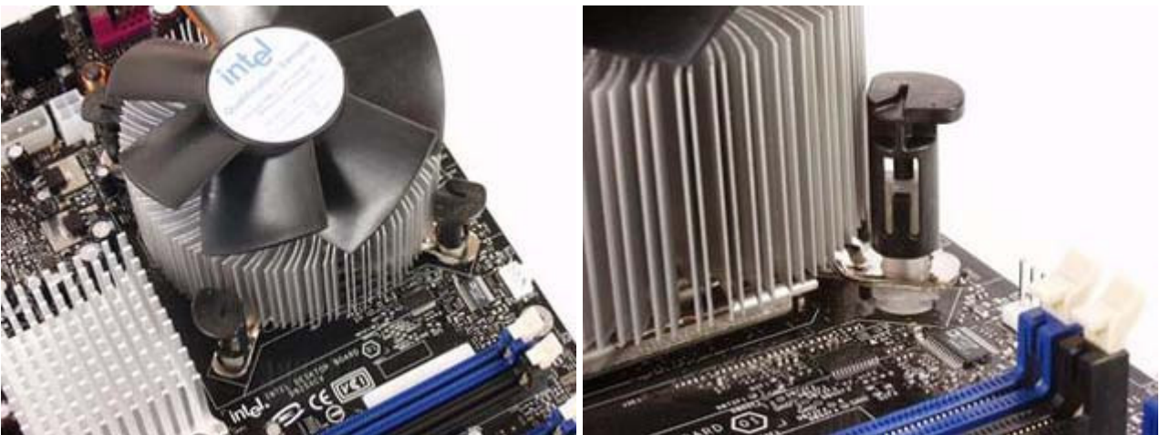
Ventilador de 775 montado donde podemos ver bien los enganches del mismo.
