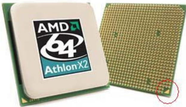
Imágenes de un micro AM2 y de su zócalo. Marcada la esquina de control de posicionamiento.
