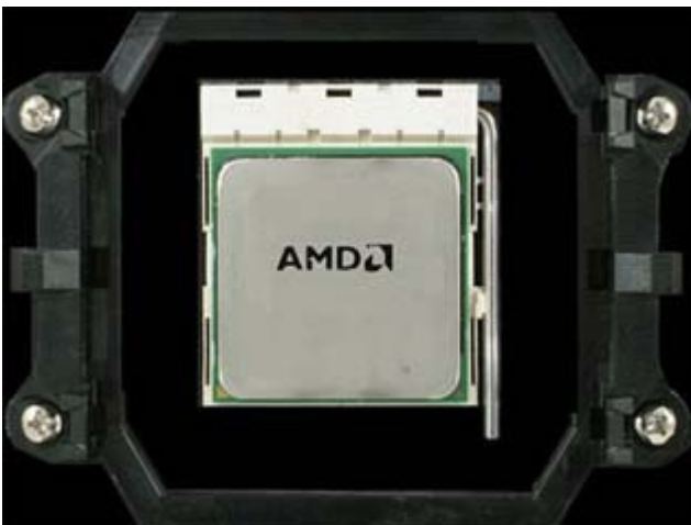
Micro AM2 colocado. A su alrededor se observa el soporte para el disipador.
