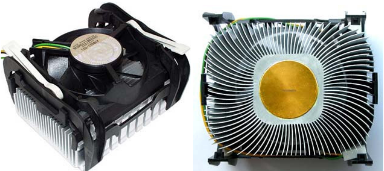
Disipador para zócalo 478. Se aprecian las palancas de fijación. A la derecha, este disipador por su parte inferior.
